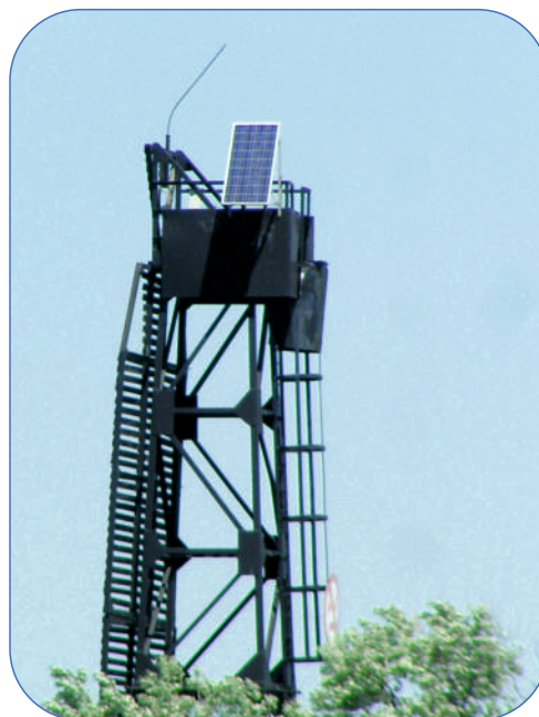
Испытания СЭУ на створном знаке. Общий вид установки.
